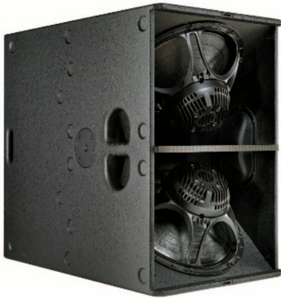
Subwoofer B30 mit zwei 15"-Treibern von Eighteen Sound. Die Bassreflexöffnung liegt mittig zwischen den beiden Treibern innerhalb der Box. Die Hochleistungstreiber sind mit Neodymmagneten und strömungsgünstigen Körben ausgerüstet.
