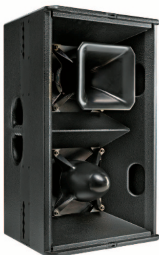
Das Hochtonhorn der T24N kann als komplette Einheit gedreht oder durch das alternative 90 × 50 Horn ersetzt werden, die Öffnungen auf den Seitenflächen des großen Horns sind Bassreflexöffnungen
