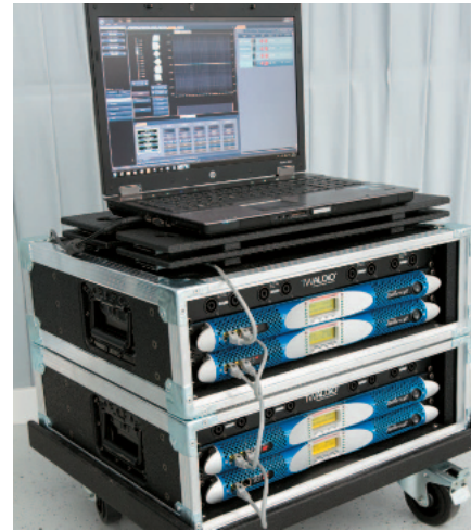
System-Amprack mit zwei Powersoft K3-DSP Endstufen. Standardmäßig werden mit einem Rack zwei Stacks mit je 2 × B30 und 1 × T24N betrieben, es sollen aber auch bis zu vier Stacks problemlos funktionieren (4 × T24 + 8 × B30, alle Kanäle 2 Ohm)
